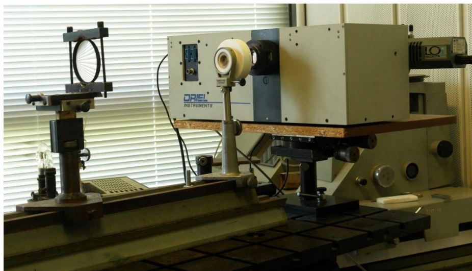
Рис. 2.2.4.1. Общий вид спектрометра MS-257 с фокусирующим конденсором и призмой Дове.
