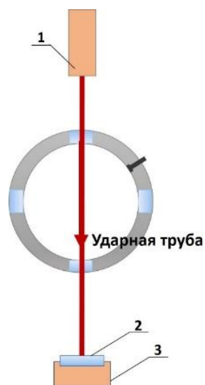
Рисунок 2.16 – Схема измерений диагностикой ЛЭ: 1 – лазер (HeNe или диодный), 2 – узкий интерференционный светофильтр, 3 – фотодетектор.
