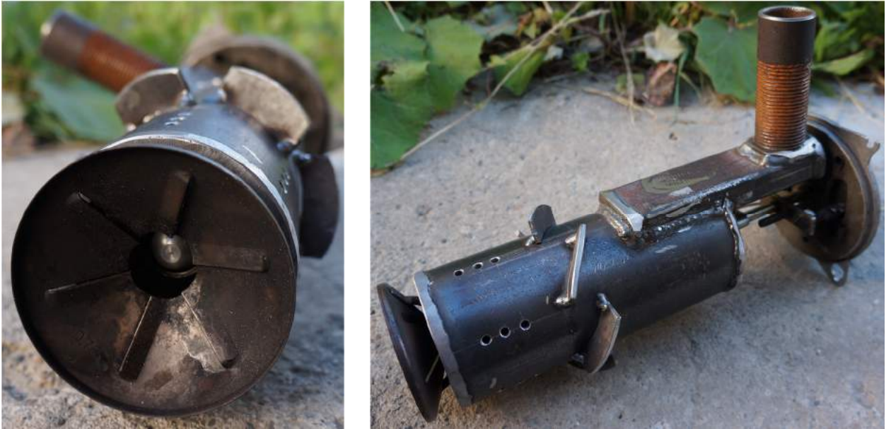
Рисунок 4.5 – Пламенная голова жидкотопливной горелки с насадкой для совместного сжигания газообразного топлива
