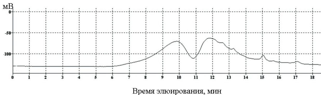
Рис. 5.1.7. Гельпроникающая хроматография продуктов ЭПП-обработки волокон коллагена: а) \tau = 5 мин, б) \tau = 10 мин
