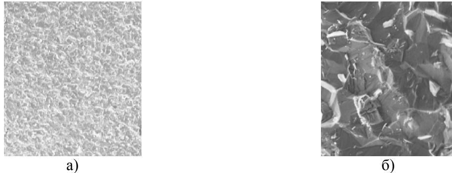
Рис. 6.2.2. SEM-Фотографии внутренней поверхности титановой трубы, обработанной в электронно-пучковой плазме кислорода: а) увеличение \times 5000 , б) увеличение \times 50\,000 Условия обработки: P_m = 5 Торр, E_b = 30 кэВ, I_b = 10 мА
