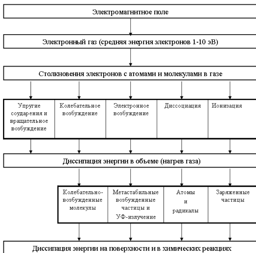
Рис. 1.1.7. Схема перераспределения энергии в неравновесной плазме газового разряда [1.1.124].
