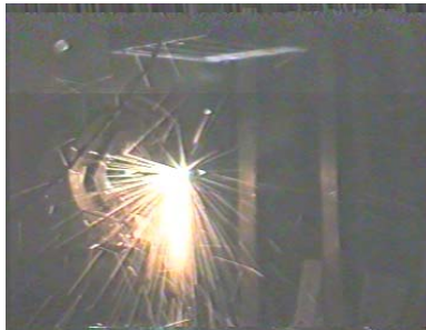
Рис. 4.4.5. Интенсивный разлет частиц КДФ ( Al_2O_3 ) при инъекции ЭП (ЭПП воздуха при P_m = 0,1 Торр)
