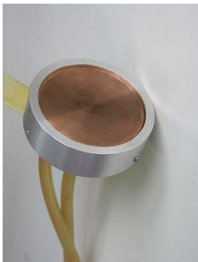
Рис. 5.3.5. Водоохлаждаемое устройство с возможностью подачи потенциала для обработки тонких пленок полисахаридов.
