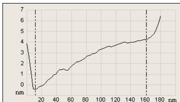
**Рис. 3.** АСМ изображение размером  $780 \times 780 \text{ нм}^2$  эшелона элементарных ступеней на поверхности расплава, затвердевшего на грани (001) НОРГ при  $p_{\text{He}} = 10.9$  МПа. Слева фрагмент профиля эшелона в направлении стрелки с семью террасами
