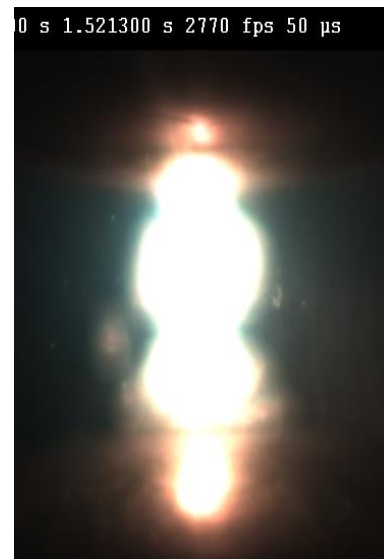
Пробой чистого трансформаторного масла
