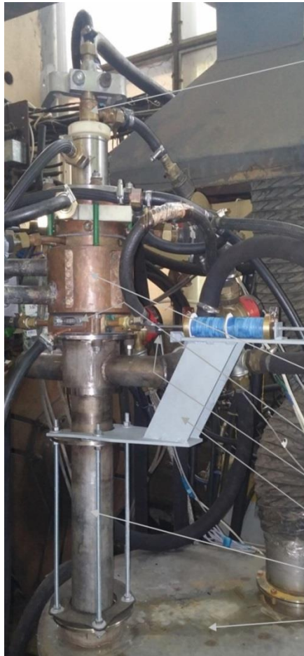
Конструкция экспериментального стенда для воздушного плазмотрона:
