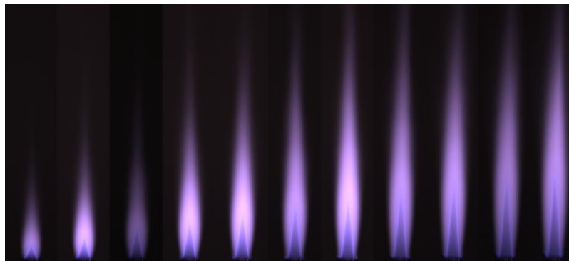
Конические метано-воздушные пламена, стабилизированные кольцом. Re: 500-3000, \phi=1
