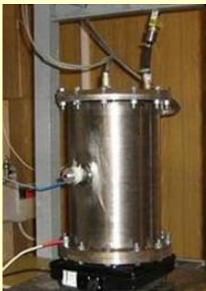
Стенд для исследований процессов влагопереноса в БМИ 02.04.2014
