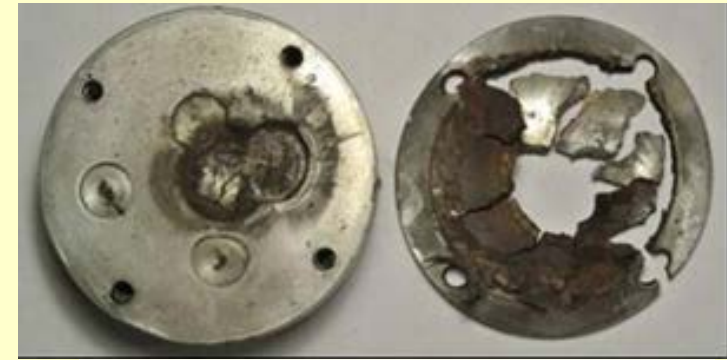
Детонация ( h = 2 мм), скорость 3,3 км/с
