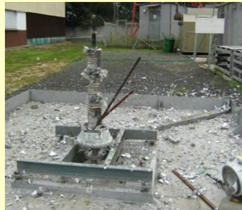
После испытаний, энергия БИИД - 1 МДж
