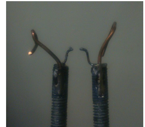
Электроды с проволокой после испытания
