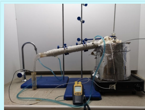
Лабораторный стенд по возгонке бионефти
