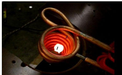
Установка по индукционному нагреву левитирующей капли: 1- капля; 2- индуктор.
