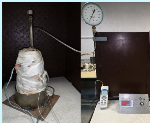
Реактор гидротермального сжижения биомассы и система управления
