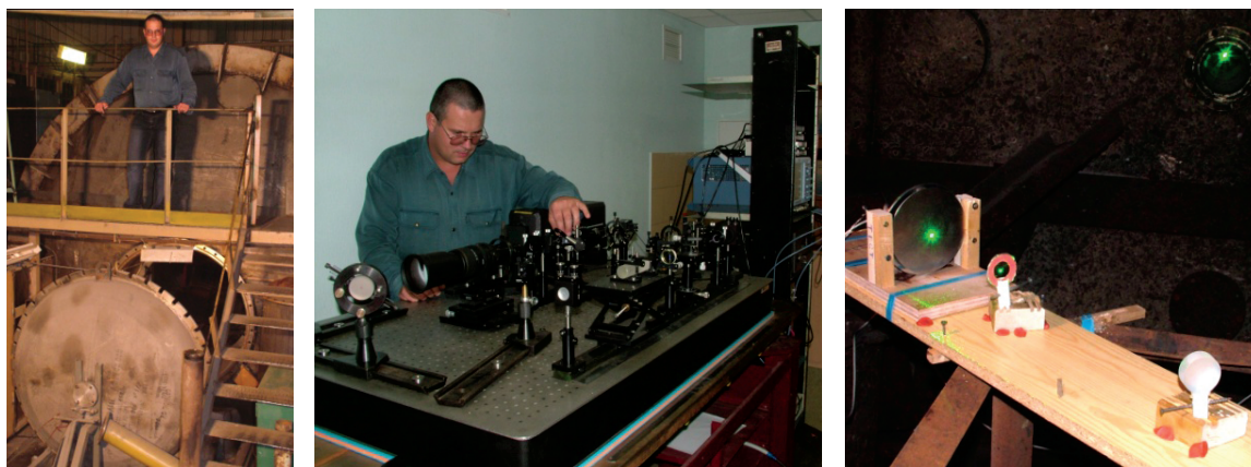
Рис. 2. Металлическая взрывная камера ОИВТ РАН и лазерный Доплеровский измеритель скорости VISAR
