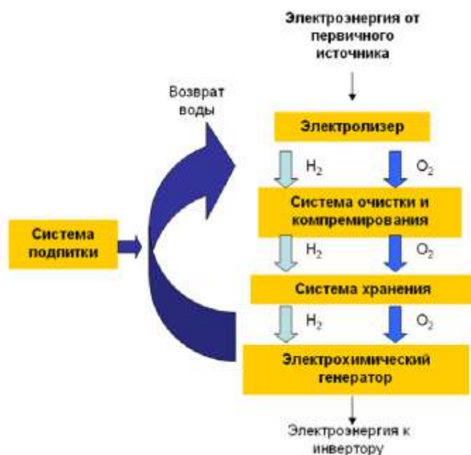
Рис.21. Принципиальная схема реализации водородного цикла аккумулирования электроэнергии с использованием электролизера и топливных элементов.
