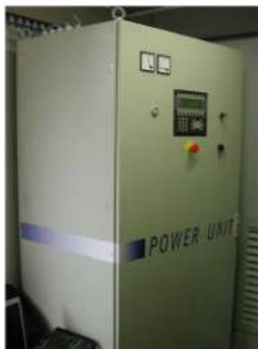
Рис. 23. Электролизер (3,6 кВт, 30 элементов по 150 см 3 , рабочее давление 30 бар) пилотной автономной солнечно-водородной энергоустановки (Agrate, Италия)
