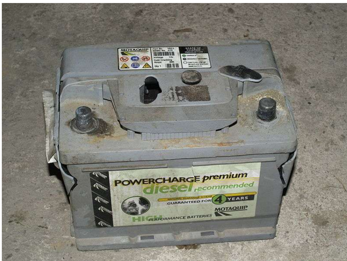
Рис.7. Взорвавшаяся в результате перезаряда батарея СКА.
