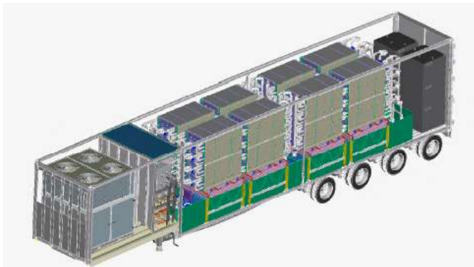
Рис.29. Мобильный накопитель электрической энергии на основе электрохимической системы Zn|Br (TransFlow2000, 2.8 МВтч, 500 кВт, компания Premium Power, США).
