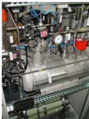
Рис. 23. Электролизер (3,6 кВт, 30 элементов по 150 см 3 , рабочее давление 30 бар) пилотной автономной солнечно-водородной энергоустановки (Agrate, Италия)
