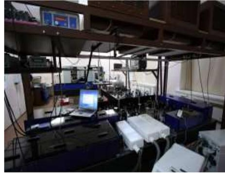
Рисунок 3. Тераваттные титан-сапфировая и хром-форстеритовая лазерные системы «Лазерного фемтосекундного комплекса» ОИВТ РАН
