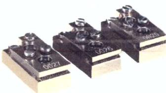
Лазерные линейки поставляются на открытом теплоотводе типа L-package. Размер излучающей площадки лазерной линейки занимает более 90 % ширины теплоотвода, что позволяет использовать несколько лазерных линеек одновременно для накачки твердотельных лазеров.
