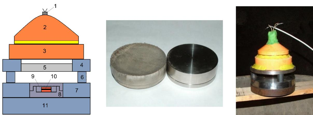
Рисунок 1.5 — схема, ампулы сохранения и общий вид экспериментальной сборки; 1 — детонатор; 2 — генератор ударной волны; 3 — взрывчатка; 4 — направляющее кольцо; 5 — ударник; 6 — столбики; 7 — охрannое кольцо; 8 — основание ампулы сохранения; 9 — крышка ампулы сохранения; 10 — медные прокладки; 11 — основание
