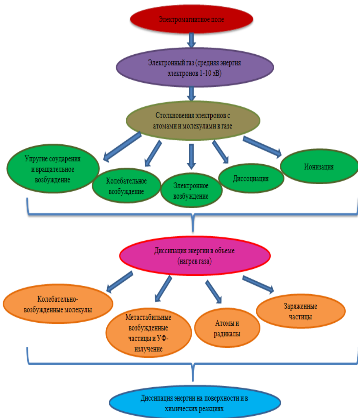
Рис. 1.1.5. Схема перераспределения энергии в неравновесной плазме газового разряда [1.1.23].
