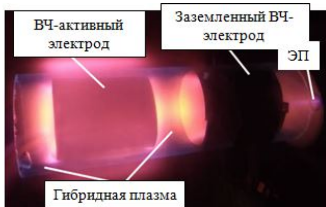
Рис. 3.1.3. Стабильный режим генерации гибридной плазмы в кварцевой трубке. Плазмообразующий газ – воздух.
