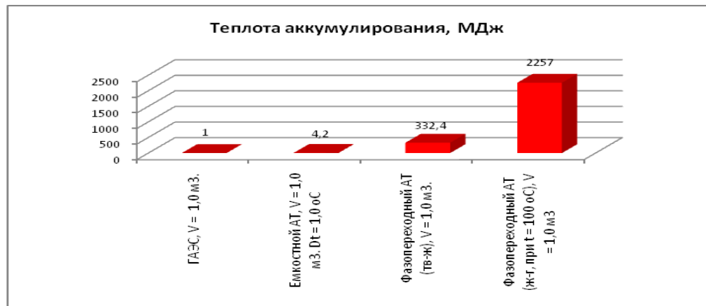
Рисунок 1.8 – Сравнение количества аккумулируемой теплоты водой в разных типах АТ
