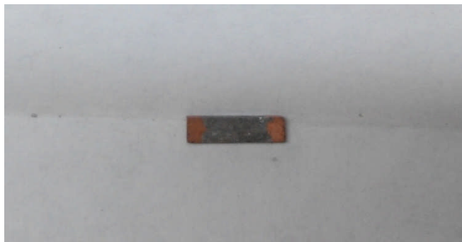
Рисунок 15 – Фотография образца, торцы которого прошли процедуру меднения
