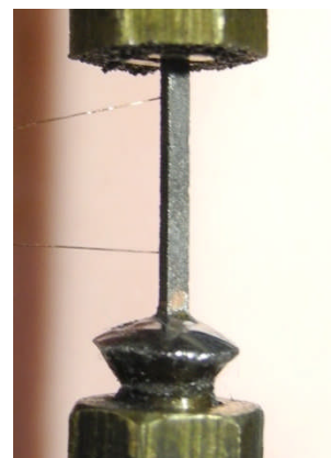
Рисунок 12 – Фотография образца из \text{MoC}_{0,82} сечением 0,74 x 0,9 и длиной 8,5 мм, закрепленного в рабочей ячейке КВД с подвижной цангой
