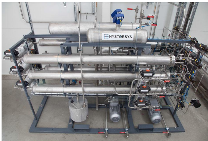
Рисунок 22 – Двухступенчатый МГ ТСК НУМЕНС–10 [94, 140]
