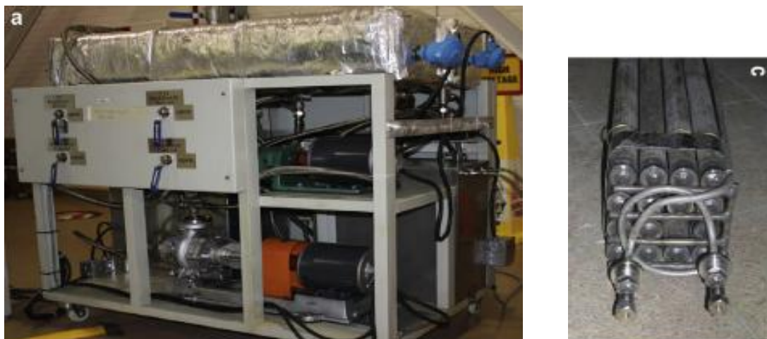
Рисунок 23 – Дожимной металлгидридный компрессор автономной водородной заправочной станции [141]
