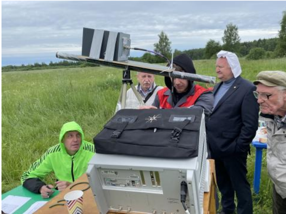
Рисунок 5.8 – Регистрация СШП-сигналов на уровне 2 метра от поверхности Земли.
