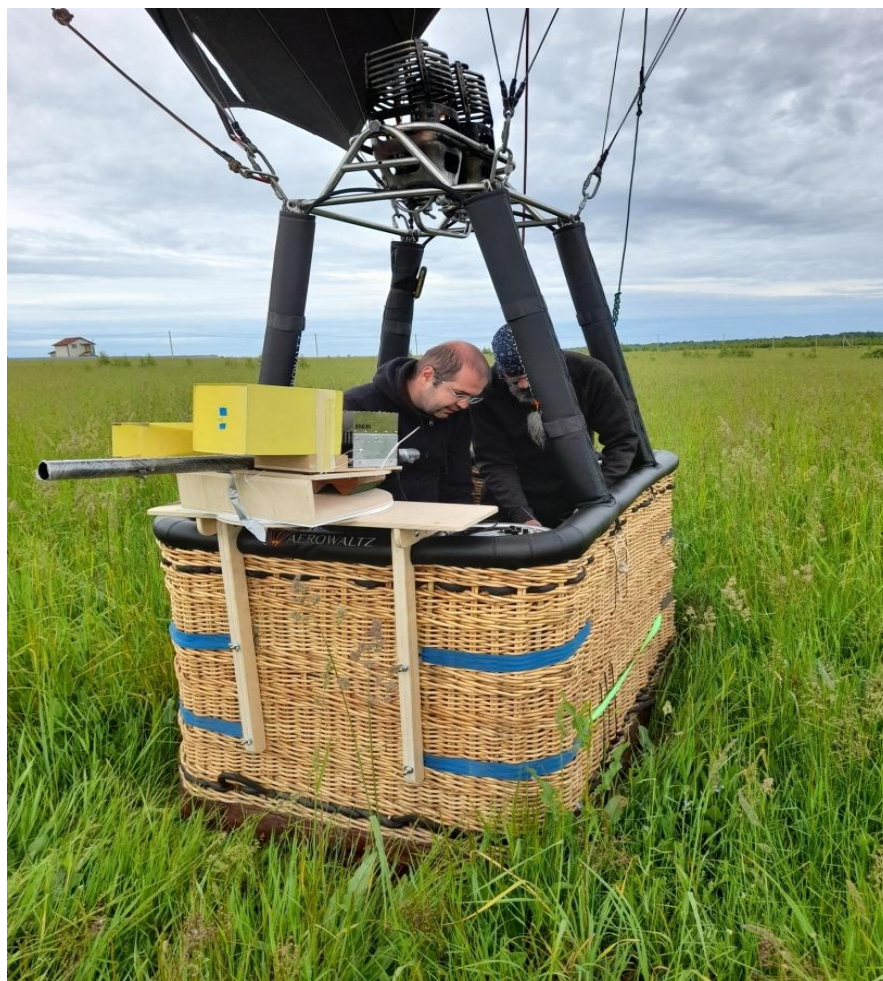
Рисунок 5.7 – Фотография размещения двух излучателей и визирной трубки в корзине подъемного шара.
