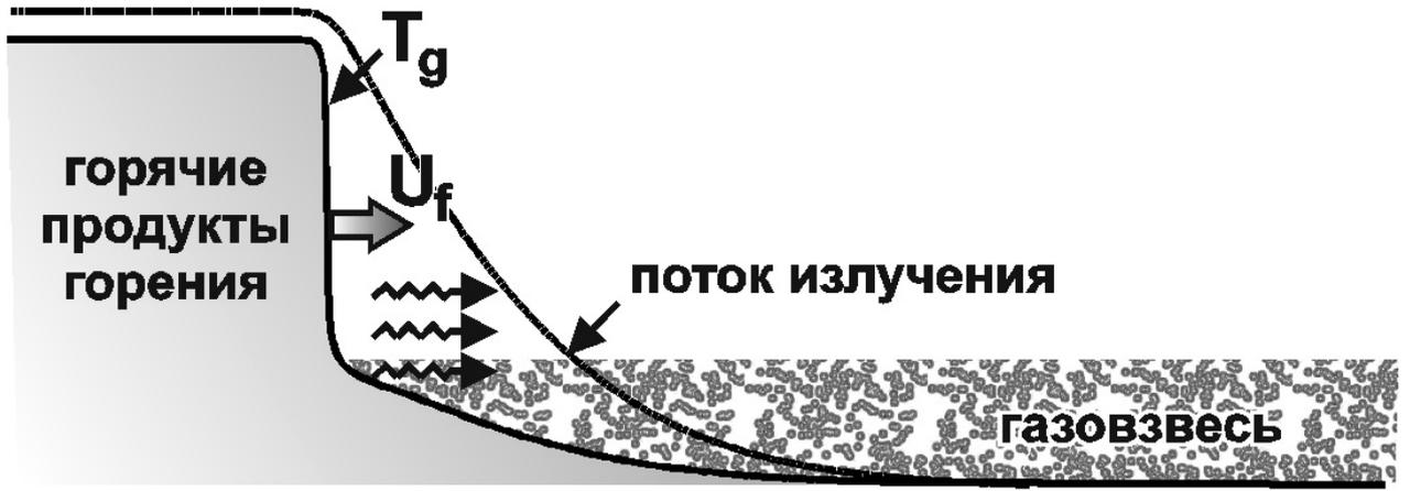
Рисунок 4.1 — Схема распространения пламени по газозвеси с равномерным распределением частиц.
