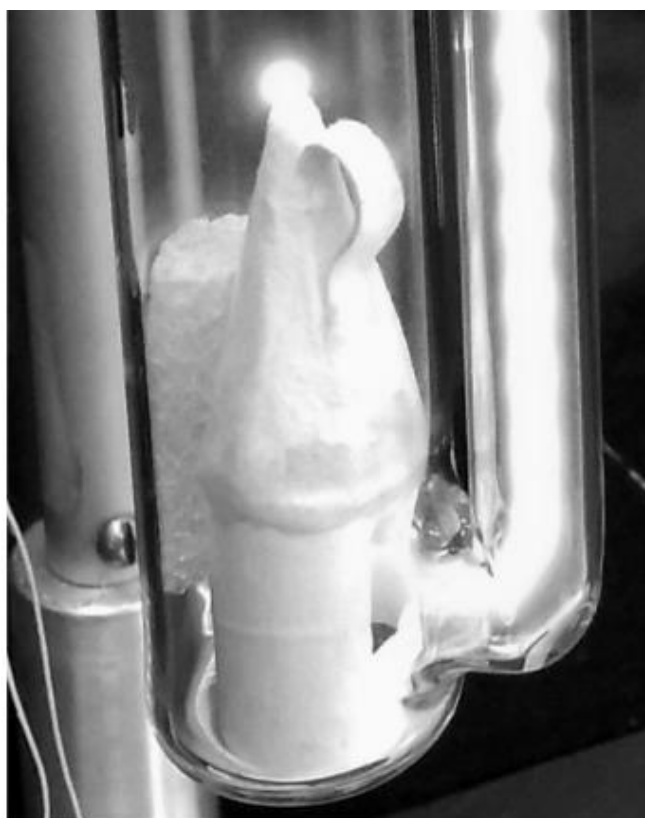
Рисунок 3.9 – Фотография нижней части трубки с горящим тлеющим разрядом.
