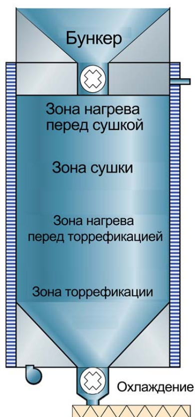
Рисунок 1.11 – Принципиальная схема реактора с подвижным слоем
