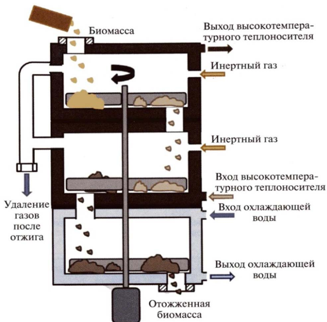
Рисунок 1.10 – Схема тарельчатого реактора [27]
