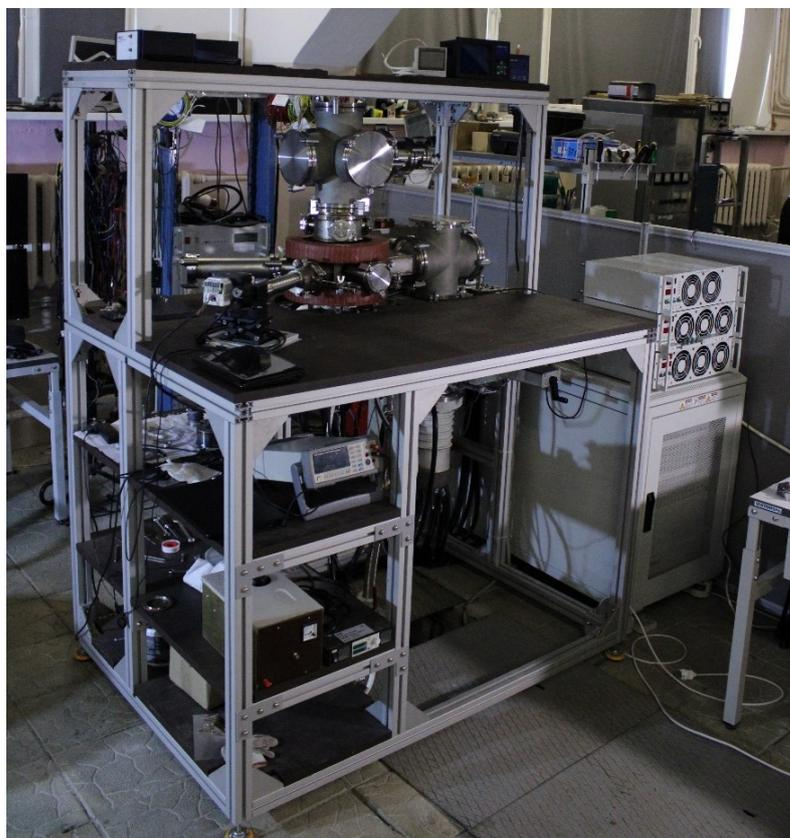
Рис. 5.15. Фотография созданного экспериментального стенда для исследования вакуумного дугового разряда в аксиальном магнитном поле
