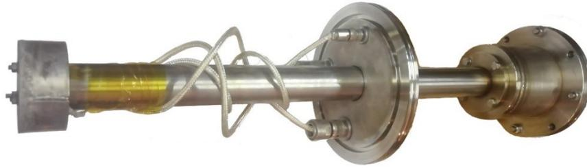
Рис. 2.2. Фотография созданного времяпролетного масс-спектрометра.
