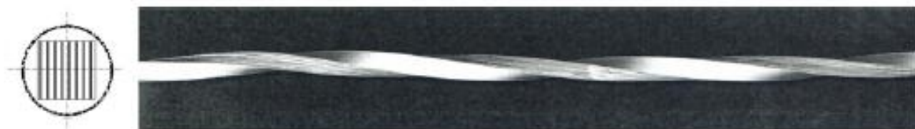
Рисунок 1.6 – Твистированный стек (стопка) ВТСП лент
