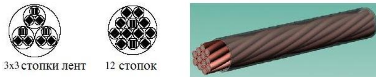
Рисунок 1.10 – Проект «кабеля в кондуите» из нескольких ТНЭ типа «твистированный стек» [17]
