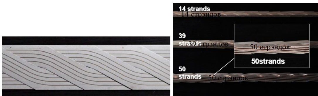
Рисунок 1.8 – Способы дальнейшего уменьшения потерь и увеличения рабочего тока [10]
