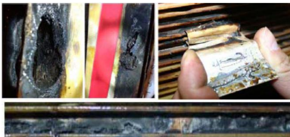
Рисунок 1.29 – Различные повреждения ВТСП обмотки в результате КЗ
