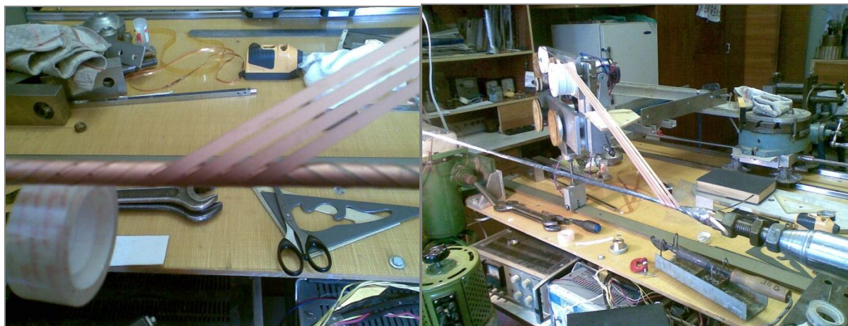
Рисунок 4.6 – Процесс намотки слоя из 4 лент 2-м слоем (а) и на формер (б)
