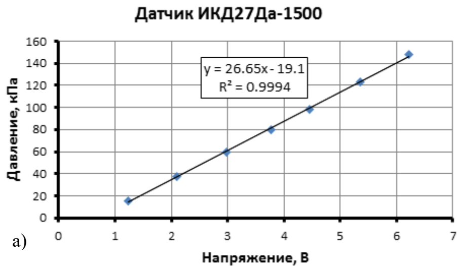
Рис.2.9 – Тарировочная характеристика датчика статического давления ИКД27Да-1500 (а) и датчика полного давления Honeywell ML300PS2PC (б)
