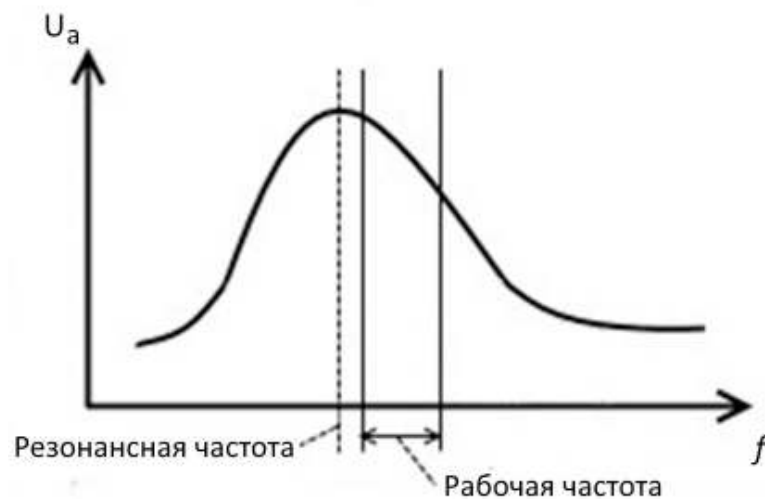
Рис. 2.3. Зависимость амплитуды напряжения на выходе резонансного контура от частоты накачки
