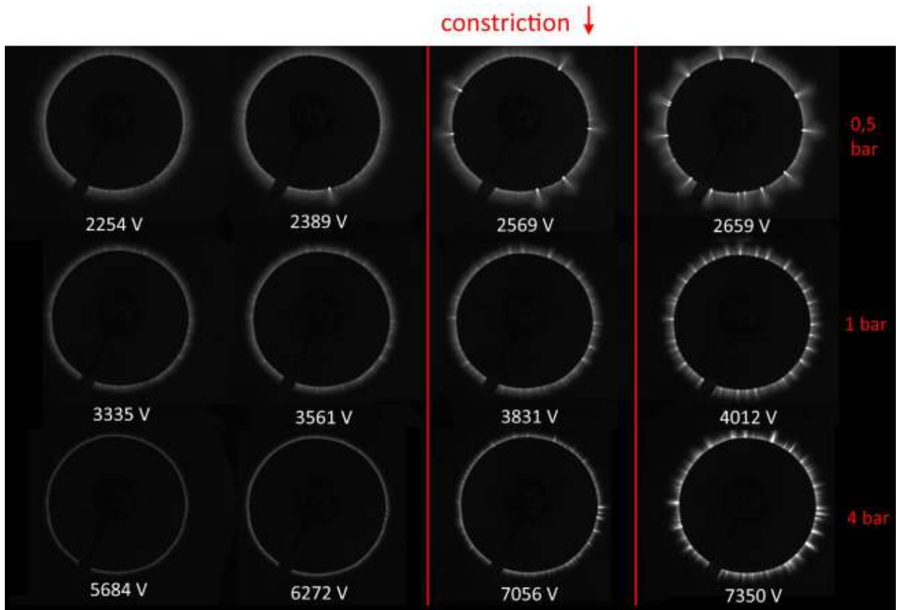
Рис. 2.15. CCD – изображения ПДБР, полученные при различных амплитудах питающего напряжения и давлениях. Красными линиями обозначен момент наступления контракции
