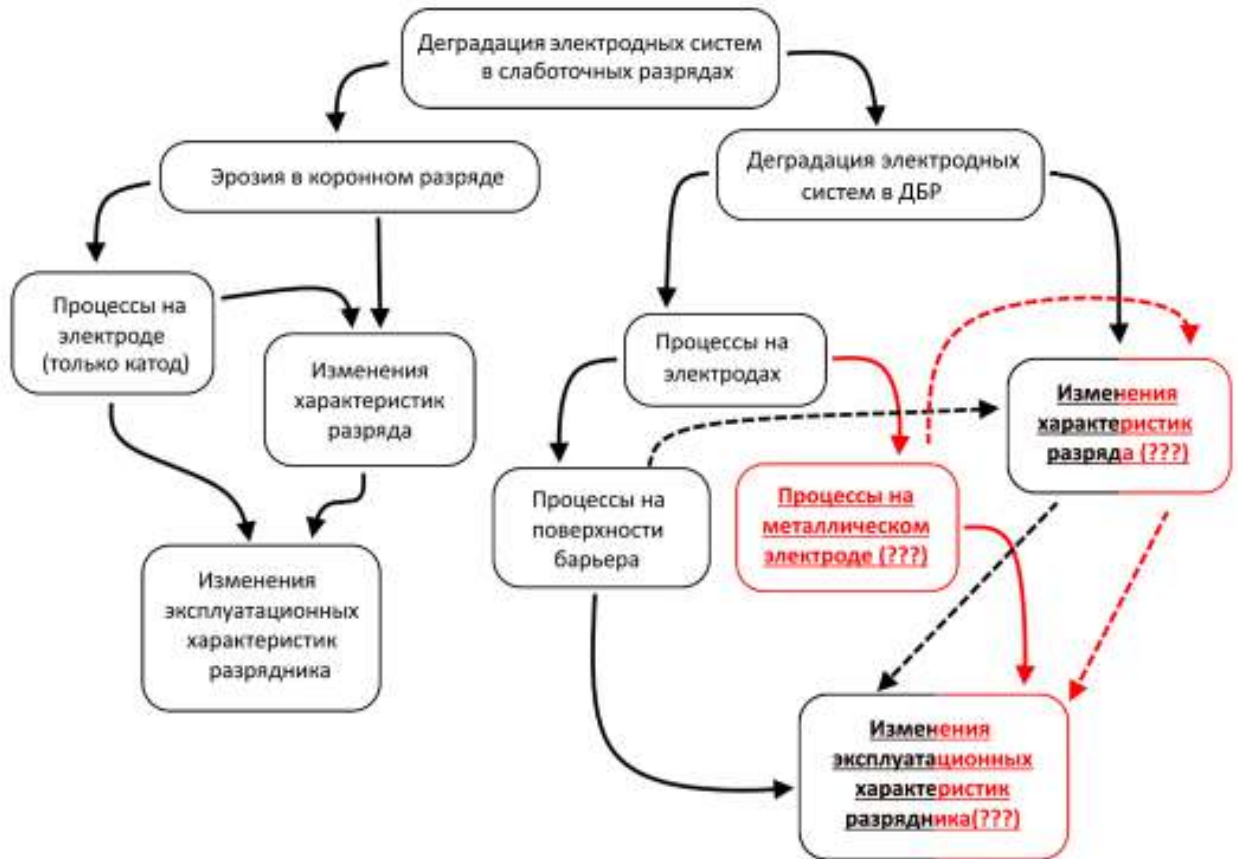
Рис. 1.38. Схематичное изображение представленного в литературе объема данных, посвященных исследованию деградации электродов в слаботочных импульсных разрядах. Сравняются близкие по параметрам коронный разряд и пДБР. Стрелками показано логическая последовательность описаний явлений. Красным цветом представлены практически не описанные аспекты деградации ДБР-разрядников.
