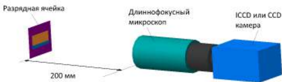
Рис. 2.12. Схема эксперимента с оптической регистрацией разряда
