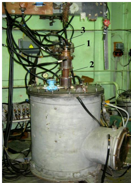
Рисунок 2.6 – Фотография установки при разложении в реакторе газообразных углеводородов. 1 – плазматрон, 2 – реактор, 3 – тройник для смешения газов. Обозначения на схеме: 1 – плазматрон, 2 – реактор, 3 – вакуумная камера, 4 – баллон с плазмообразующим газом, 5 – редуктор, 6 – регулятор транспортирующего газа, 7 – регулятор плазмообразующего (рабочего) газа, 8 – баллон с углеводородом, 9 – ЦПУ, 10 – компьютер, 11 – вихревая рециркуляционная зона, 12 – вакуумирующая система, 13 – сажевый осадок, 14 – система водяного охлаждения.
