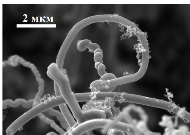
Рисунок 6.7 – Морфология углеродных нановолокон, полученных при пиролизе C_2H_2 в плазме Ar при 150 Торр.
