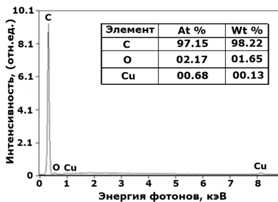
Рисунок 6.15 – Локальный энергодисперсионный анализ образца, синтезированного при конверсии смеси C_2H_2 / He.
