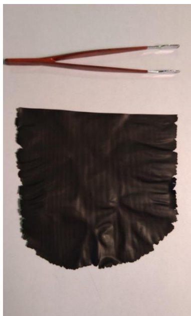
Рисунок 8.20 – Фотография электродной массы с графеном (обр.№2), полученного методом каландрирования.
