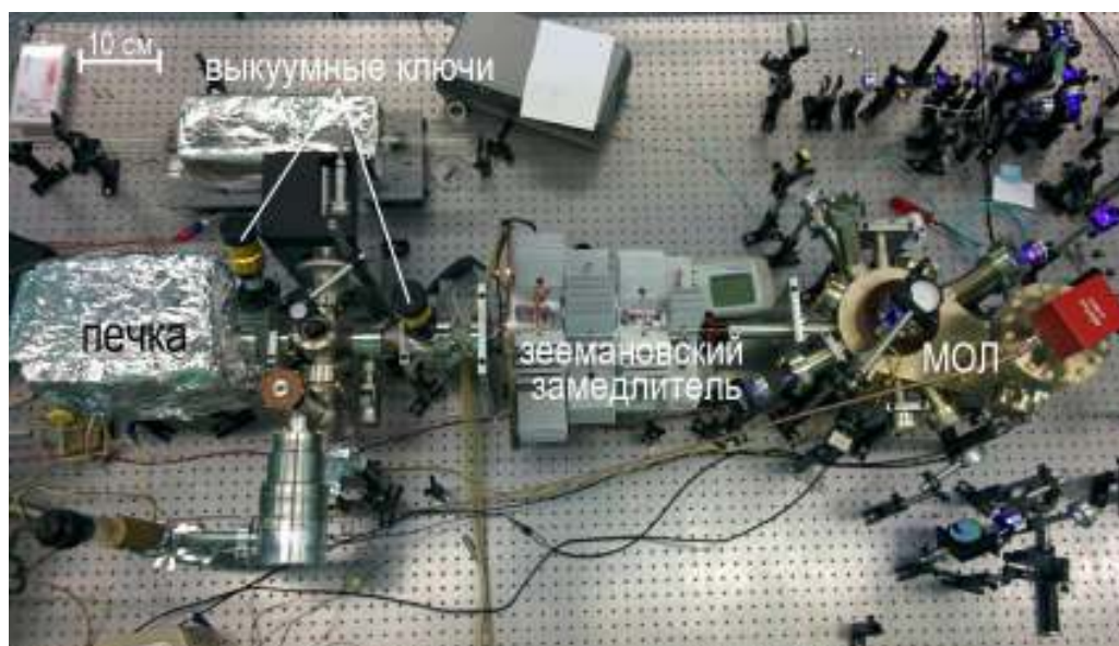
Рис. 1.1 — Фотография установки по лазерному охлаждению атомов кальция-40
