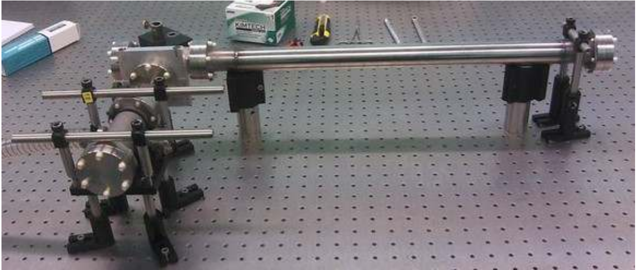
Рис. 1.8 — Самодельная кювета для наблюдения резонансов насыщенного поглощения в парах кальция
