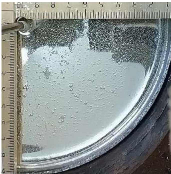
Рисунок 2.17 – Пузырьки водорода на поверхности жидкого металла In-Ga-Sn.
