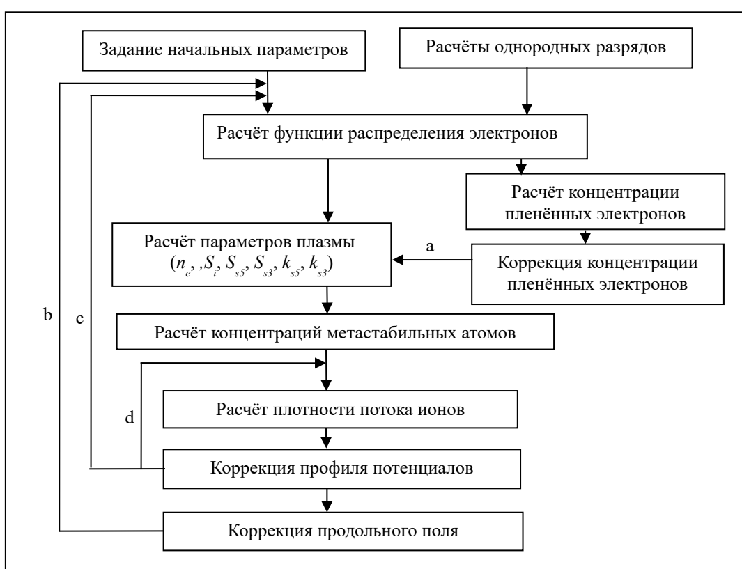
Рисунок 4.1 - схема расчёта пространственно-неоднородного положительного столба разряда постоянного тока.
