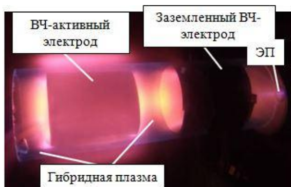
Рис. 2. Стабильный режим генерации гибридной плазмы в кварцевой трубке. Плазмообразующий газ – воздух.
