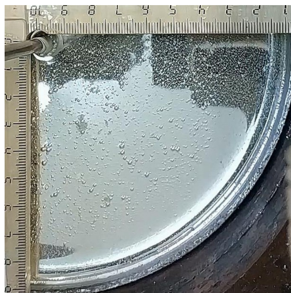
Рисунок 4 – Пузырьки водорода на поверхности жидкого металла In-Ga-Sn.
