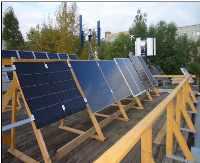
Стенд сравнительных испытаний фотоэлектрических модулей
