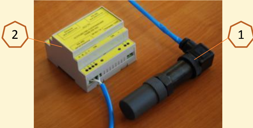
1 - датчик влажности, 2 - модуль сопряжения, к которому можно подключать до 16 датчиков влажности.
