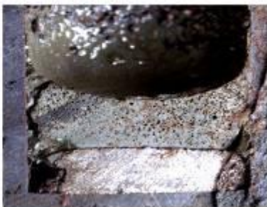
Железный сплав под слоем силикатного шлака
