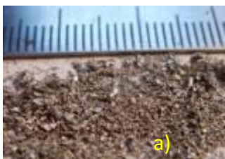
Вид осколков после фрагментации. (а) - тонкая фрагментация; (б) – полые фрагменты; (в) – застывшие струи.
