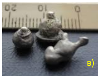
Вид осколков после фрагментации. (а) - тонкая фрагментация; (б) – полые фрагменты; (в) – застывшие струи.
