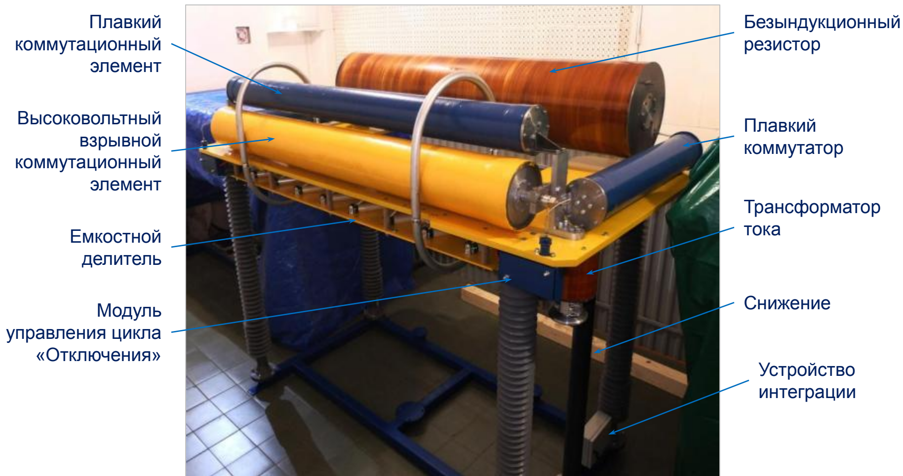
Общий вид ТОУ-220 на производственной площадке ШФ ОИВТ РАН
