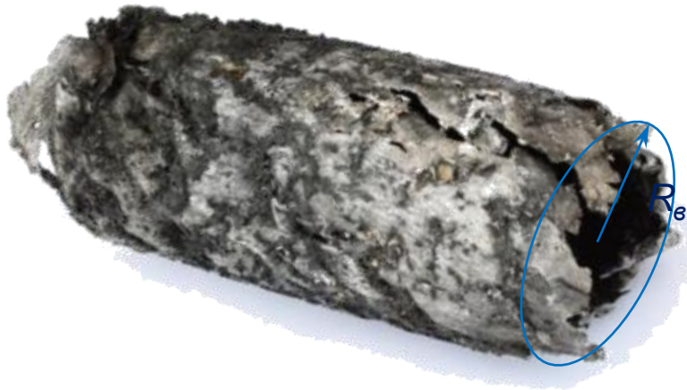
Оболочка после десятикратного сжатия вернулась к исходному размеру
