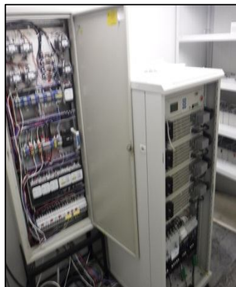
Стенд испытаний инверторов и гибридных схем аккумулирования выработки солнечных батарей мощностью до 7 кВт (совместно с лаб. 2.1.2.1 (Беляев И.А))
