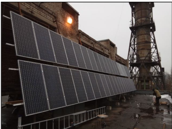
Стенд испытаний инверторов и гибридных схем аккумулирования выработки солнечных батарей мощностью до 7 кВт (совместно с лаб. 2.1.2.1 (Беляев И.А))
