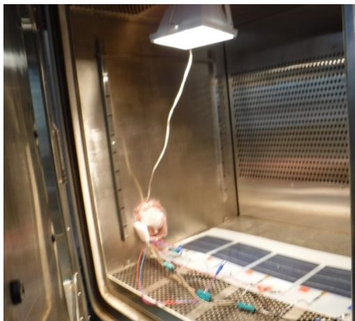
Стенд ресурсных испытаний ФЭП и минимодулей с использованием климатической камеры
