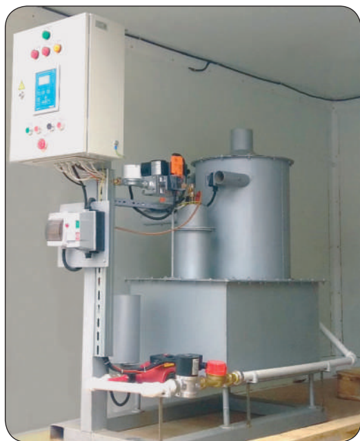
Рис. 2. Опытный образец КПН мощностью 100 кВт.
