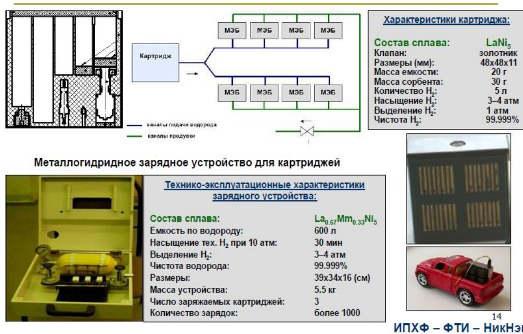
Рисунок 7 - Водородный картридж для портативного топливного элемента мощностью 2 Вт и зарядное устройство для картриджей
