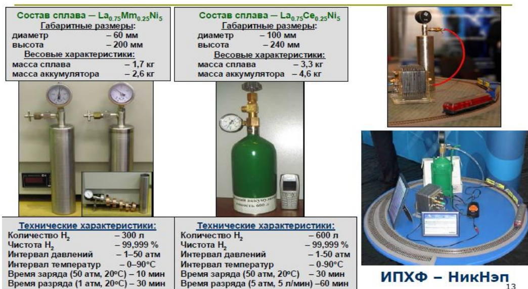
Рисунок 8 - Металлогидридные аккумуляторы водорода для топливных элементов мощностью 100-500 Вт
