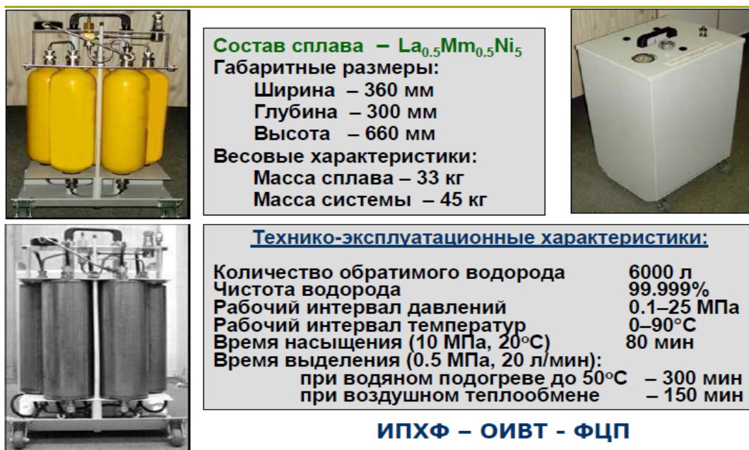
Рисунок 9 - Система очистки и хранения водорода для питания топливного элемента мощностью 5 кВт
