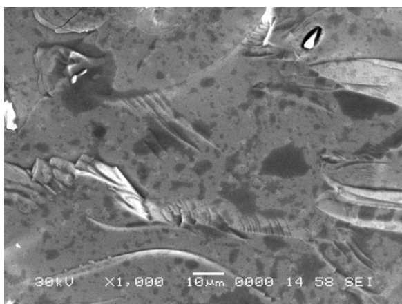
Рисунок 2 - Изображение сплава \text{LaFe}_{0,1}\text{Mn}_{0,3}\text{Ni}_{4,8} , полученное с помощью микроскопа Hitachi TM1000. Увеличение \times 1000 раз.
