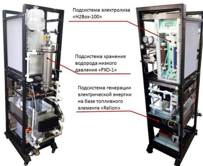
Рис. 2. Общий вид энергоустановки H2Smart
