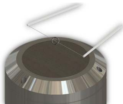
Рисунок 2. Схема установки сверхтонкой термопары над горелкой.
